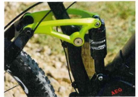
**HINTERBAU-SCHWINGE:** Der einstellbare Suntour-Luft-Dämpfer steuert die Hinterbau-Auslenkung.
