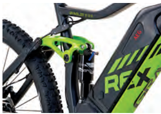
Suntour Raidon Dämpfer ermöglicht 120 mm Federweg.
